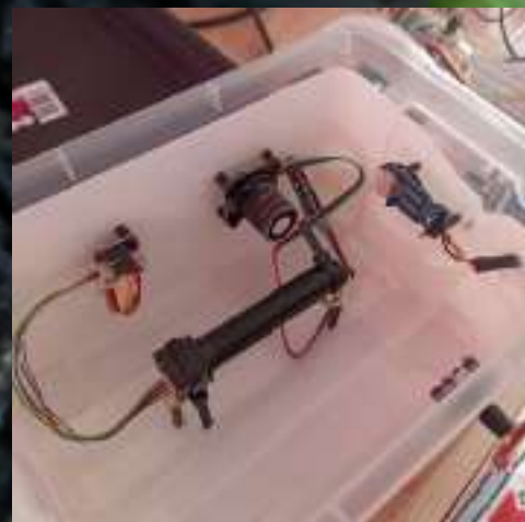
station de mesure ( prototype ) avec analyse de CO2, de dioxygène, d'hygrométrie, de luminosité, entre autres
