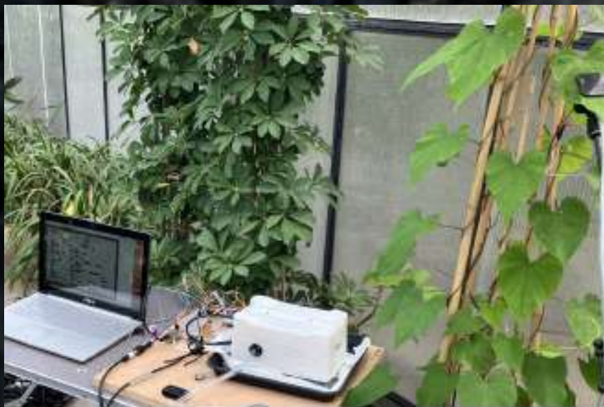
station de mesure ( prototype ) avec boîtier imprimé en 3D envoyant de l'air dans la feuille pour analyser les émissions en «sortie».
