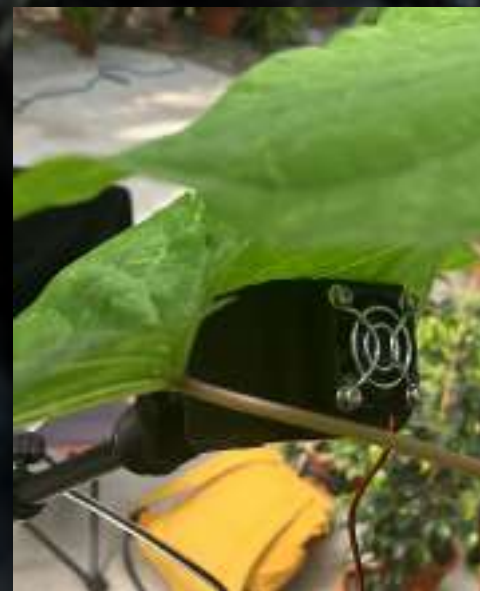
station de mesure ( prototype ) avec boîtier imprimé en 3D envoyant de l'air dans la feuille pour analyser les émissions en «sortie».
